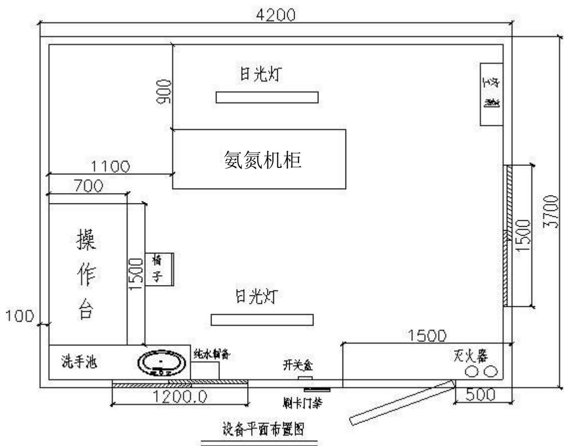
图 4.3 工作站安装（建议）平面示意图
