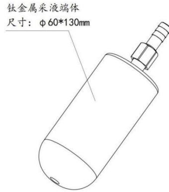
图 6.2 钛金属采液端体尺寸 (mm)
