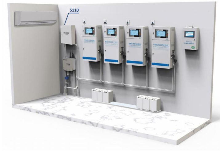
图 6.12 监测站房（进场水）安装布局
