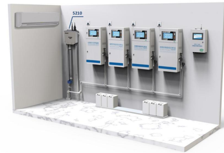
图 6.13 监测站房（出场水）安装布局
