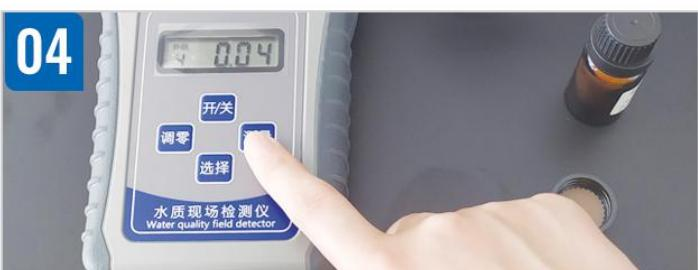
时间到达后，旋紧定位器盖，将样品瓶外壁用擦拭布擦拭干净，放入主机测量池中，按“测量”键，此时液晶上显示的数值即为该水样中臭氧含量值。
