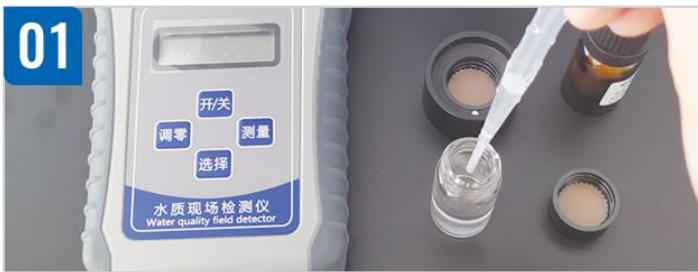
按“开关”键将检测仪开机，按“选择”键选择参数3(二氧化氯)检测项目。先用待测水样对样品瓶进行3-4次的冲洗(冲洗时须盖紧瓶盖)，然后用塑料吸管吸取被测水样至样品瓶10毫升刻度线处。
