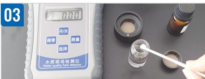
取出样品瓶加入试剂A 4滴，然后盖紧样品瓶瓶盖摇匀溶解，再加入试剂B一平勺，摇匀溶解，用计时器准确计时30秒，静置显色。
