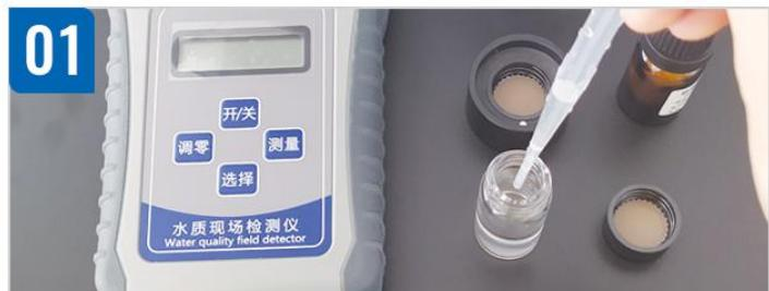
按“开关”键将检测仪开机，按“选择”键选择参数1(余氯)检测项目。先用待测水样对样品瓶进行3-4次的冲洗(冲洗时须盖紧瓶盖)，然后用塑料吸管吸取被测水样至样品瓶10毫升刻度线处。
