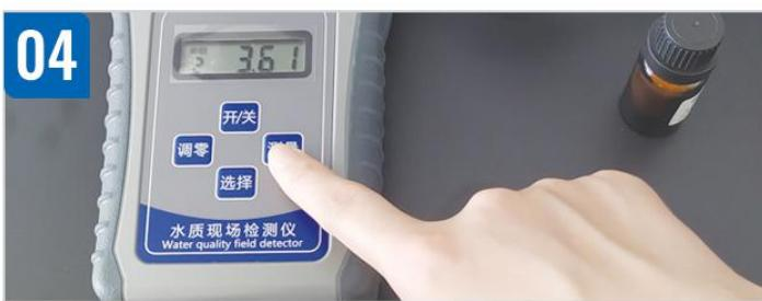
时间到达后，旋紧定位器盖，将样品瓶外壁用擦拭布擦拭干净，放入主机测量池中，按“测量”键，此时液晶上显示的数值即为该水样中总余氯含量值。
