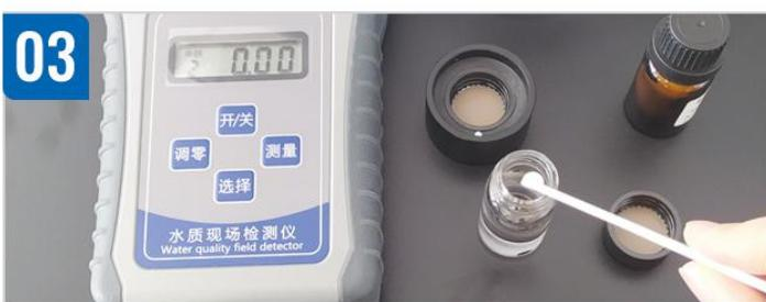
取出样品瓶加入总余氯试剂A一平勺，然后盖紧样品瓶瓶盖，摇匀溶解，再加入总余氯试剂B一平勺，摇匀溶解，用计时器准确计时1分钟，静置显色。
