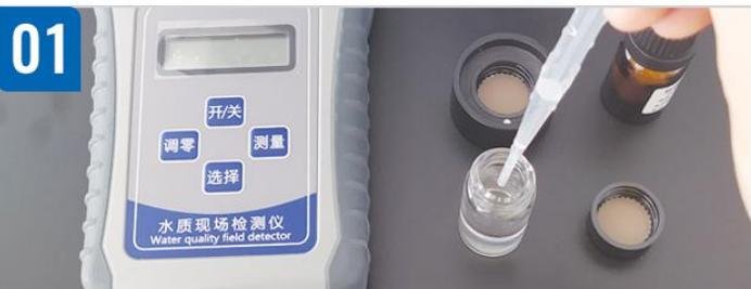
按“开关”键将检测仪开机，按“选择”键选择参数4(臭氧)检测项目。先用待测水样对样品瓶进行3-4次的冲洗(冲洗时须盖紧瓶盖)，然后用塑料吸管吸取被测水样至样品瓶10毫升刻度线处。
