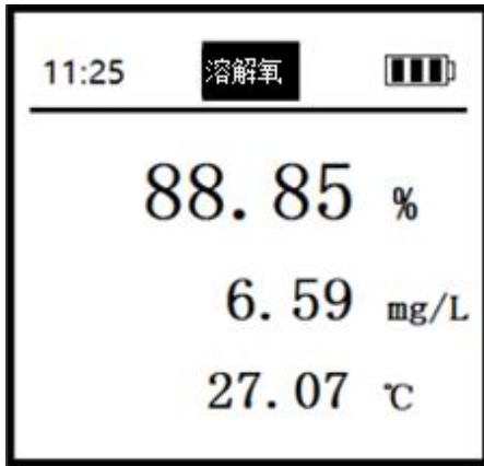
溶氧界面：包括溶解氧百分比，溶解氧 mg/L 和温度°C。
