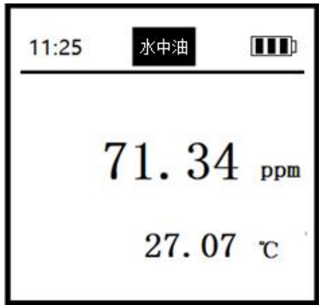
水中油界面：包括水中油 ppm 和温度°C。水中油单位会根据实际探头类型显示 ppm 或 ppb。
