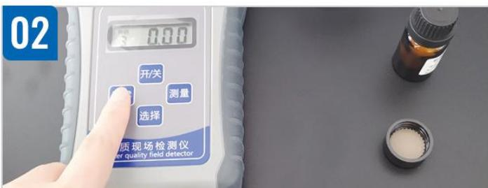
将样品瓶旋紧定位器盖，用擦拭布将样品瓶外壁擦拭干净，然后放入主机测量池中，按“调零”键，当仪器液晶显示“0.00”时，代表完成自动调零。
