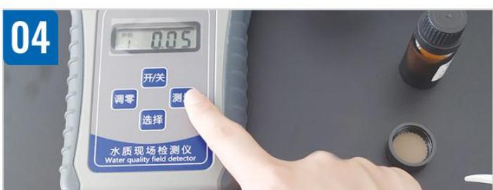
时间到达后，旋紧定位器盖，将样品瓶外壁用擦拭布擦拭干净，放入主机测量池中，按“测量”键，此时液晶上显示的数值即为该水样中余氯含量值。
