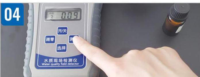
时间到达后，旋紧定位器盖，将样品瓶外壁用擦拭布擦拭干净，放入主机测量池中，按“测量”键，此时液晶上显示的数值即为该水样中二氧化氯含量值
