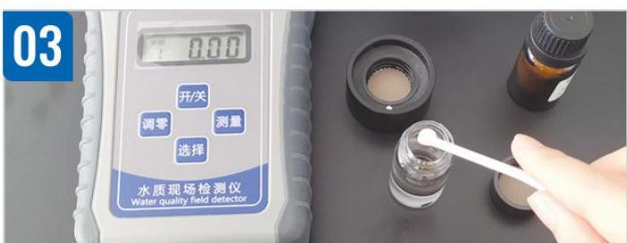
取出样品瓶加入余氯试剂一平勺，然后盖紧样品瓶瓶盖，摇动约20秒使标志物完全溶解，用计时器准确计时1分钟，静置显色。
