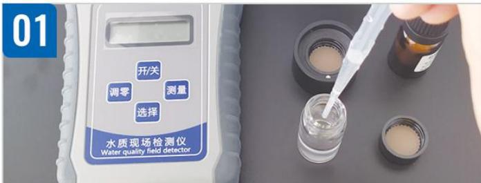
按“开关”键将检测仪开机，按“选择”键选择参数2(总余氯)检测项目。先用待测水样对样品瓶进行3-4次的冲洗(冲洗时须盖紧瓶盖)，然后用塑料吸管吸取被测水样至样品瓶10毫升刻度线处。
